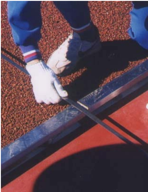
内圏縁石の計測（公認検定）
